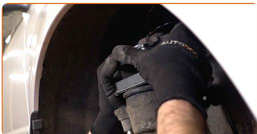
**23** Montare la pinza del freno e fissarla. Usa una chiave HEX N.H7. Usa una chiave dinamometrica. Serralo fino allo coppia di torsione di 30 Nm.
