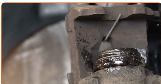
**20** Premere il pistone della pinza freno. Usa un arretratore per pistoncini freni a disco.
