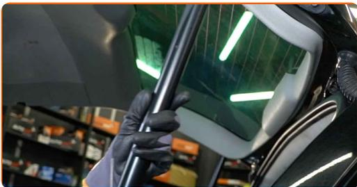
**6** Sgancia l'anello elastico che collega il puntello di supporto a gas alla carrozzeria dell'auto. Usa un giravite piatto.
