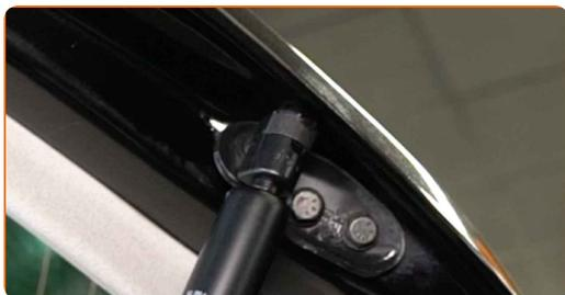
**12** Fai scattare l'anello elastico che collega il puntello di supporto a gas alla carrozzeria dell'auto.
