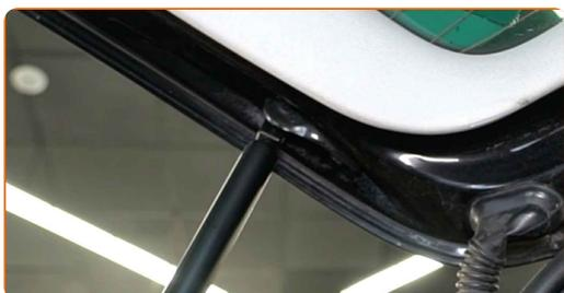
**15** Fai scattare l'anello elastico che collega il puntello di supporto a gas alla carrozzeria dell'auto.
