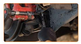
Rimuovi il clip di fissaggio del cavo del freno a mano. Usa un cacciaspina. Usa un martello.
