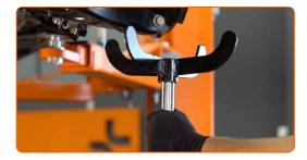
Pulisci la superficie del disco freno. Usa una spazzola metallica. Tratta la superfice nella quale il disco freno fa contatto con il cerchione della ruota. Usa il grasso al rame.
