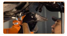
Svitare il fissaggio della staffa di sostegno al braccio. Utilizza una chiave a bussola N°18. Usa una chiave a cricchetto.
