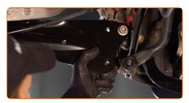
Serra gli elementi di fissaggio che collegano il braccio di sospensione allo snodo posteriore. Utilizza una chiave a bussola N°18. Usa una chiave dinamometrica. Serralo fino allo coppia di torsione di 90 Nm. +90°
