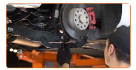
Pulisci gli elementi di fissaggio del braccio di controllo. Usa una spazzola metallica. Usa lo spray WD-40.
