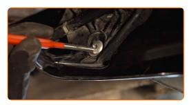
Installare l'elemento che fissa l'asta allo stabilizzatore e serrarlo. Utilizza una chiave combinata N°16. Utilizza una chiave a bussola N°16. Usa la chiave XZN n.6. Usa una chiave dinamometrica. Serralo fino allo coppia di torsione di 45 Nm.
