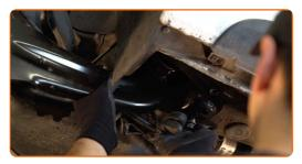
Avvita gli elementi di fissaggio che collegano il braccio posteriore alla carrozzeria dll'auto. Utilizza una chiave a bussola N°15. Usa una chiave dinamometrica. Serralo fino allo coppia di torsione di 50 Nm. +45°
