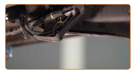
Svita gli elementi di fissaggio che collegano il braccio di sospensione allo snodo posteriore. Utilizza una chiave a bussola N°18. Usa un giramaschi.
