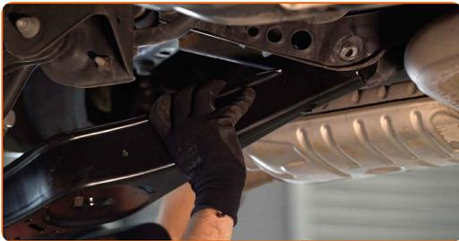
**18** Installa gli elementi di fissaggio del braccio di sospensione.
