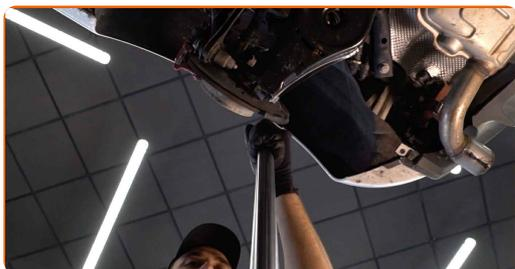
**24** Installa gli elementi di fissaggio del sistema di scarico.
