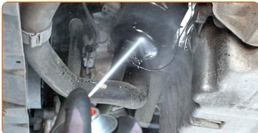
**11** Svitare il tappo dell'alloggiamento del filtro insieme al vecchio elemento filtrante. Utilizza una chiave a bussola N°36. Usa una chiave a cricchetto.
