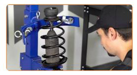
Installare il supporto di ammortizzazione nell'arco passaruota.
