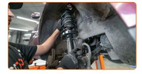
Serrare il dado di fissaggio superiore del supporto di ammortizzazione. Non lo serrare.
