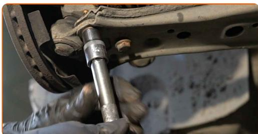
**55** Stringi gli elementi di fissaggio del giunto sferico. Utilizza una chiave a bussola N°13. Usa una chiave dinamometrica. Serralo fino alla coppia di torsione di 20 Nm. +90°
