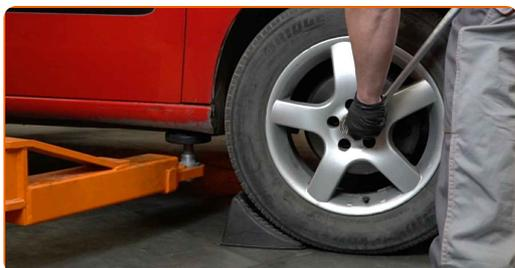
**8** Sollevare la parte anteriore del veicolo e fissarlo per mezzo di appoggi.
