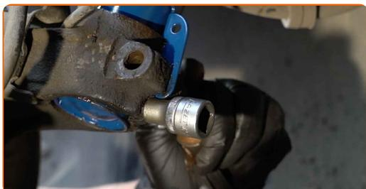
**50** Rimuovi il supporto da sotto il fuso a snodo.
