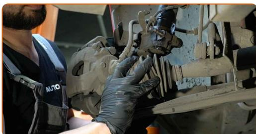
**27** Puntellare il fuso a snodo. Usa un cric idraulico per trasmissione.
