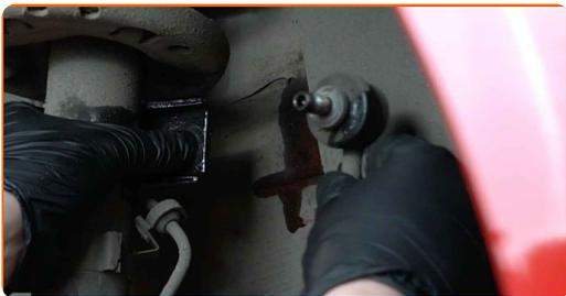
**16** Pulire la staffa supporto del cablaggio ABS. Usa una spazzola metallica. Usa lo spray WD-40.
