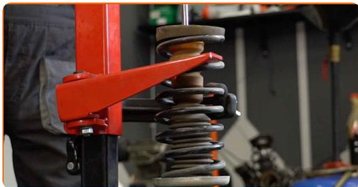
**25** Rimuovi il parapolvere e il paracolpi dell'ammortizzatore.
