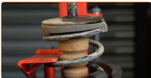
**22** Rimuovere il dado del montante del supporto di ammortizzazione. Utilizza una chiave combinata N°17. Usa la chiave a bussola per ammortizzatore Nr. DD5,2. Usa una chiave a cricchetto.
