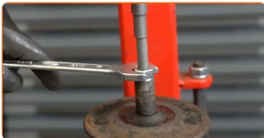
Sostituzione: ammortizzatore a molla - SEAT TOLEDO I (1L). AUTODOC raccomanda:
