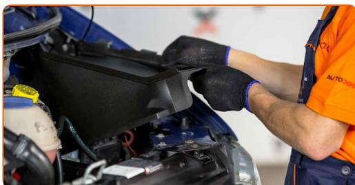
**4** Rimuovi le staffe di supporto degli elementi di fissaggio dei tubi flessibili del filtro carburante. Usa un giravite piatto.
