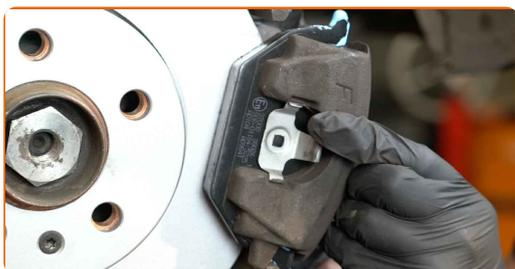
**18** Montare i tappi dei parapolvere delle guide pinza freno.
