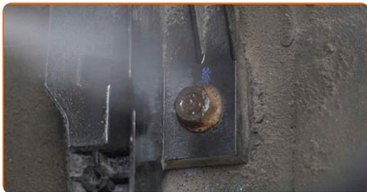
**13** Svitare l'elemento di fissaggio del contenitore per carbone attivo. Utilizza una chiave a bussola N°13. Usa una chiave a cricchetto.
