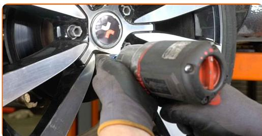
**51** Rimettere il veicolo per terra e, lavorando in ordine incrociato, serrare i bulloni di fissaggio delle ruote. Usa la chiave a bussola per dadi cerchio ruota n.17. Usa una chiave dinamometrica. Serralo fino allo coppia di torsione di 120 Nm.
