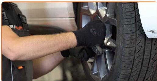
**17** Rimettere il veicolo per terra e, lavorando in ordine incrociato, serrare i bulloni di fissaggio delle ruote. Usa una chiave dinamometrica. Serralo fino allo coppia di torsione di 120 Nm.
