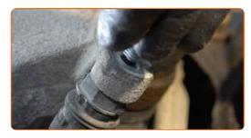
Serra gli elementi di fissaggio della pinza del freno. Utilizza una chiave a bussola N°13. Usa una chiave dinamometrica. Serralo fino allo coppia di torsione di 35 Nm.
