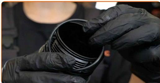
**18** Installa il nuovo filtro dell'olio alla sede di montaggio del coperchio del filtro.
