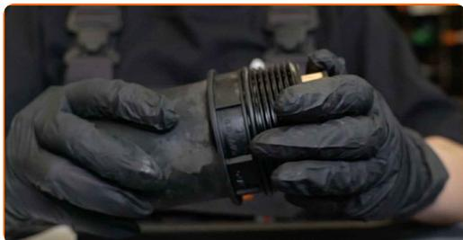
**19** Lubrifica la guarnizione di gomma del filtro nuovo con una piccola quantità di olio fresco.
