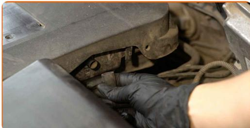
**4** Rimuovi il coperchio del motore assemblato con la scatola del filtro dell'aria.
