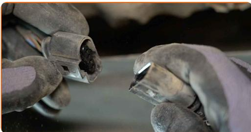
**8** Pulire l'elemento di fissaggio del sensore di ossigeno. Usa una spazzola metallica. Usa lo spray WD-40.
