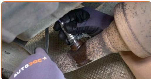
**14** Stringere l'elemento di fissaggio del sensore di ossigeno. Utilizzare una chiave poligonale aperta#22. Usa una chiave dinamometrica. Serralo fino allo coppia di torsione di 37 Nm.
