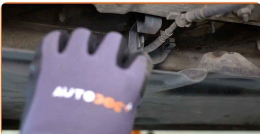
**6** Scollegare il cablaggio del sensore di ossigeno (sonda lamda). Usa uno strumento per estrazione clip.
