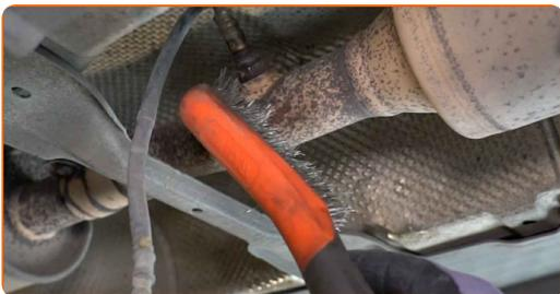
**9** Svitare l'elemento di fissaggio del sensore di ossigeno. Utilizzare una chiave poligonale aperta#22.
