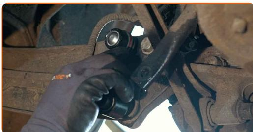
**14** Serra gli elementi di fissaggio del tirante della barra stabilizzatrice. Utilizza una chiave combinata N°16. Usa la chiave XZN n.6. Usa una chiave a cricchetto.
