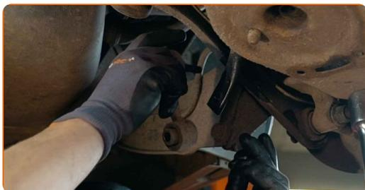
**12** Pulisci le sedi di montaggio del tirante della barra stabilizzatrice. Usa una spazzola metallica. Usa lo spray WD-40.
