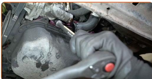
**9** Rimuovere l'alloggiamento del termostato.
