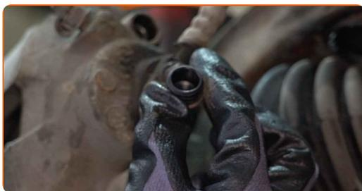
**9** Svitare gli elementi di fissaggio della pinza del freno. Usa una chiave HEX N.H7. Usa una chiave a cricchetto.
