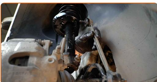
**Sostituzione: biellette barra stabilizzatrice - SEAT IBIZA V (KJ1). Il consiglio degli esperti di AUTODOC:**
