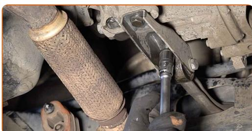
**8** Svita gli elementi di fissaggio che collegano il supporto del motore al telaio ausiliare. Utilizza una chiave a bussola N°16. Usa una chiave a cricchetto.
