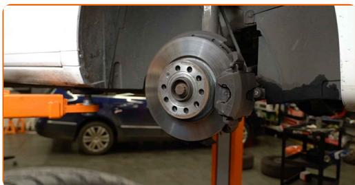
**7** Pulisci l'area in cui il tubo flessibile si collega alla pinza del freno e alla tubatura del circuito dei freni. Usa una spazzola metallica. Usa un pulitore freni.
