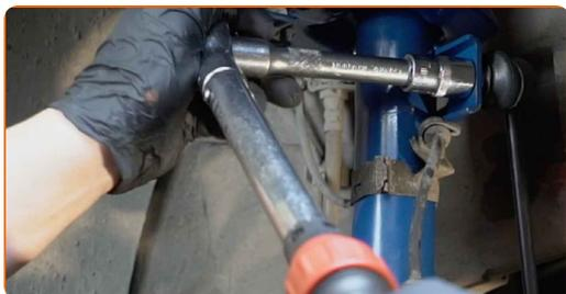
**13** Serra gli elementi di fissaggio che collegano il tirante della barra stabilizzatrice alla barra. Utilizza una chiave combinata N°17. Utilizza una chiave a bussola N°17. Usa una chiave dinamometrica. Serralo fino allo coppia di torsione di 40 Nm.
