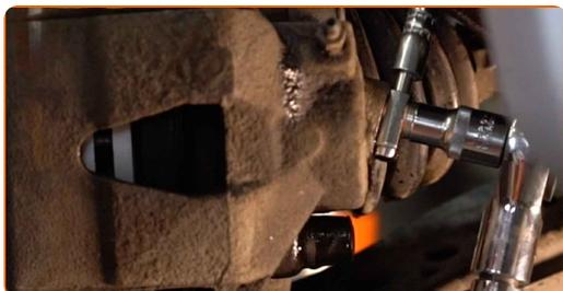
**16** Pulisci la sede di montaggio del tubo flessibile del freno sulla tubatura del circuito dei freni. Pulisci la sede di montaggio del tubo flessibile del freno alla pinza freno. Usa un pulitore freni.
