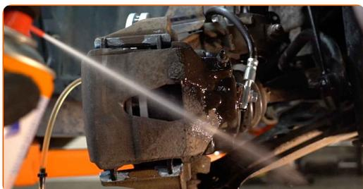
Sostituzione: tubi freno - SEAT Ibiza III Hatchback (6L). AUTODOC raccomanda:
