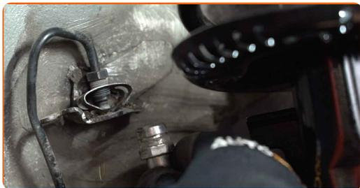
**14** Avvita il tubo flessibile del freno sulla tubatura del circuito dei freni. Utilizza una chiave combinata N°11. Usa una chiave dinamometrica. Serralo fino allo coppia di torsione di 15 Nm.
