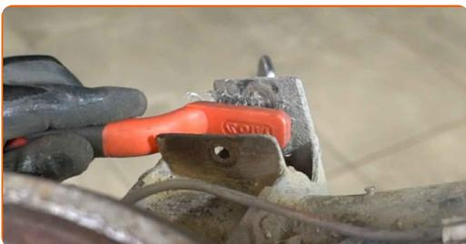
**25** Installare il supporto di ammortizzazione nell'arco passaruota.
