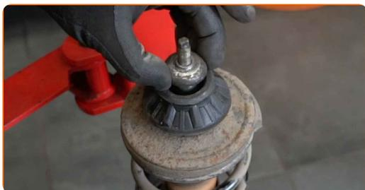
Sostituzione: supporto ammortizzatore - SEAT Ibiza II (6K1). AUTODOC raccomanda:
