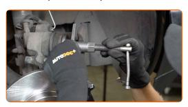
Montare la pinza del freno e fissarla. Usa una chiave HEX N.H6. Usa una chiave dinamometrica. Serralo fino allo coppia di torsione di 25 Nm.
