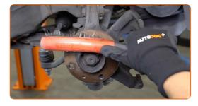
Pulire il supporto della pinza del freno da sporco e polvere. Usa una spazzola metallica. Usa un pulitore freni.
