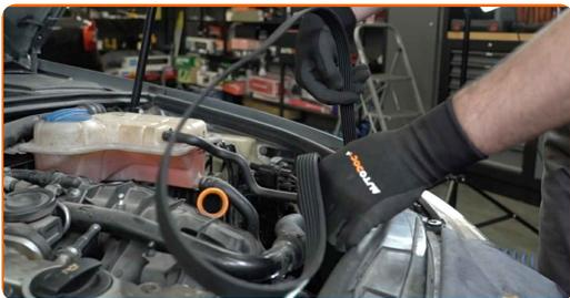
Sostituzione: cinghia poly-v - SEAT Exeo ST (3R5). AUTODOC raccomanda:
