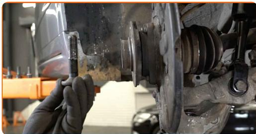
**23** Pulisci gli elementi di fissaggio del sensore ABS. Usare una spazzola pulente in nylon. Usa un detergente spray multiuso.
