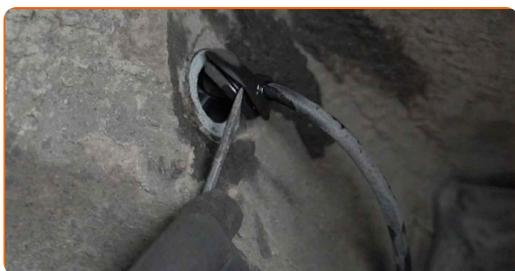
**25** Scollega il connettore del sensore di velocità ABS.
