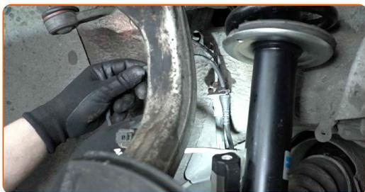
**73** Collega il connettore del sensore di velocità ABS.
