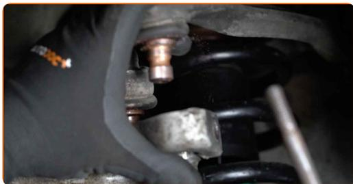
**30** Pulisci l'elemento di fissaggio che collega le testine tiranti al fuso a snodo. Usa una spazzola metallica. Usa lo spray WD-40.
