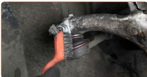
**31** Allentare il bullone di fissaggio della testina sterzo. Utilizza una chiave a bussola N°13. Usa una chiave a cricchetto.
