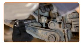
Svita l'elemento di fissaggio che collega la barra stabilizzatrice al braccio di sospensione. Utilizza una chiave a bussola N°13. Usa una chiave a cricchetto.
