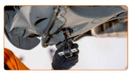
Serra l'elemento di fissaggio che collega la barra stabilizzatrice con il braccio di sospensione. Utilizza una chiave a bussola N°13. Usa una chiave dinamometrica. Serralo fino allo coppia di torsione di 25 Nm.
