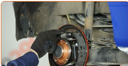
**15** Avvitare i bulloni di fissaggio del cilindro del freno. Usa la chiave Torx T30. Usa una chiave dinamometrica. Serralo fino alla coppia di torsione di 8 Nm.
