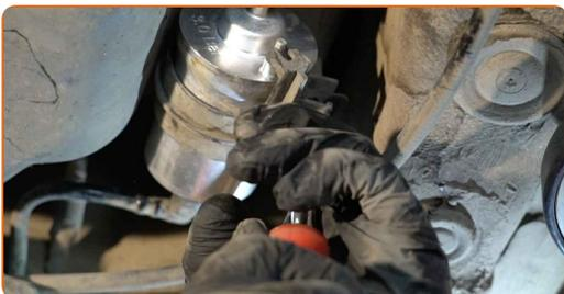
**13** Pulisci gli elementi di fissaggio dei tubi di rifornimento carburante. Usa un detergente spray multiuso.
