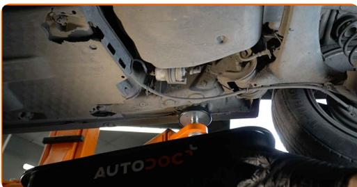
**5** Pulisci gli elementi di fissaggio dei tubi di rifornimento carburante. Usare una spazzola pulente in nylon. Usa un detergente spray multiuso.
