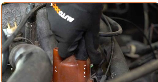
Sostituzione: calotta spinterogeno - SEAT Cordoba Vario (6K5). Il consiglio degli esperti di AUTODOC:
