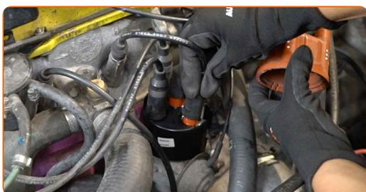
**Sostituzione: calotta spinterogeno - SEAT Cordoba Vario (6K5). Consiglio:**
