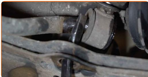
Sostituzione: biellette barra stabilizzatrice - SEAT Cordoba Vario (6K5).
