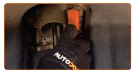
Avvita l'elemento di fissaggio inferiore dell'ammortizzatore. Utilizza una chiave combinata N°16. Utilizza una chiave a bussola N°16. Usa una chiave a cricchetto.
