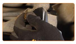
Rimuovi il supporto da sotto la trave dell'asse posteriore.
