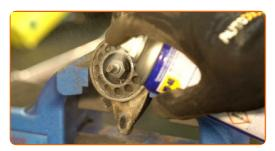
Rimuovere l'elemento di fissaggio dell'asta pistone ammortizzatore. Utilizza una chiave a bussola N°15. Usa una chiave a cricchetto.
