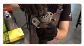
Avvitare il fissaggio superiore dell'asta pistone ammortizzatore. Utilizza una chiave a bussola N°15. Usa la chiave a bussola per ammortizzatore. Usa una chiave dinamometrica. Serralo fino allo coppia di torsione di 25 Nm.
