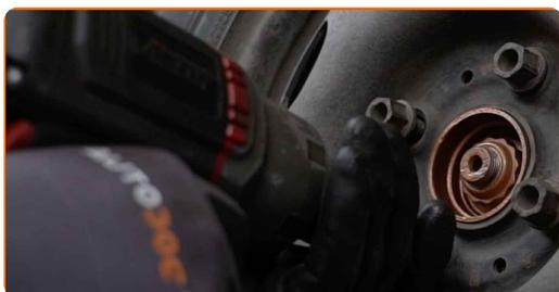
**30** Rimettere il veicolo per terra e, lavorando in ordine incrociato, serrare i bulloni di fissaggio delle ruote. Usa la chiave a bussola per dadi cerchio ruota n.17. Usa una chiave dinamometrica. Serralo fino allo coppia di torsione di 110 Nm.
