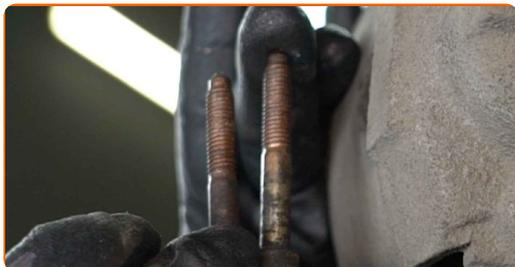
**25** Serra gli elementi di fissaggio della pinza del freno. Usa una chiave HEX N.H6. Usa una chiave dinamometrica. Serralo fino allo coppia di torsione di 25 Nm.
