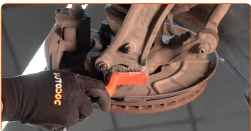
**24** Svita gli elementi di fissaggio che collegano il giunto sferico al braccio di sospensione. Utilizza una chiave a bussola N°16. Usa un giramaschi.
