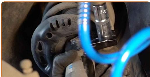
**16** Pulisci gli elementi di fissaggio della staffa del tubo flessibile. Usa una spazzola metallica. Usa lo spray WD-40.
