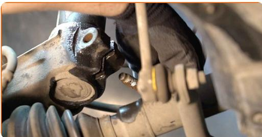
**21** Rimuovi i bulloni di fissaggio. Utilizza una chiave a bussola N°24.
