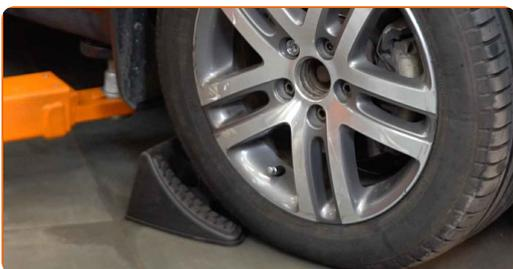
**9** Allenta l'elemento di fissaggio del mozzo della ruota. Utilizza una chiave a bussola N°24. Usa un giramaschi.
