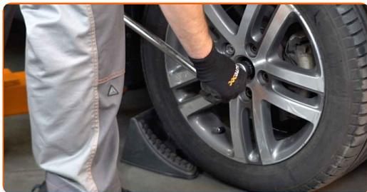
**10** Allentare i bulloni di fissaggio della ruota. Usa la chiave a bussola per dadi cerchio ruota n.17.
