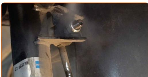
**15** Svita gli elementi di fissaggio che collegano il tirante della barra stabilizzatrice al puntone dell'ammortizzatore. Utilizza una chiave a bussola N°19. Usa una chiave a cricchetto.
