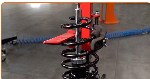
**42** Installare il parapolvere e il limitatore flessione dinamica sul nuovo ammortizzatore.
