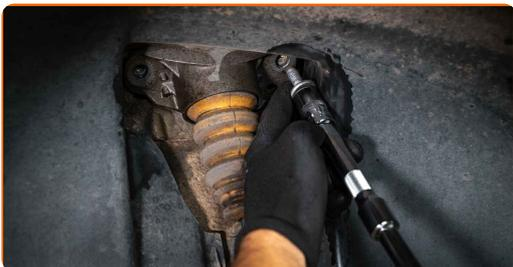
**9** Avvita l'elemento di fissaggio inferiore dell'ammortizzatore. Utilizza una chiave combinata N°21.
