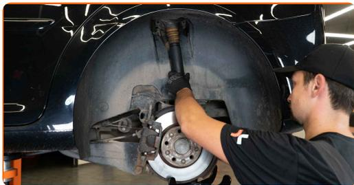
**20** Puntellare il braccio. Usa un cric idraulico per trasmissione.
