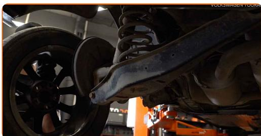
**6** Puntellare il braccio. Usa un cric idraulico per trasmissione.
