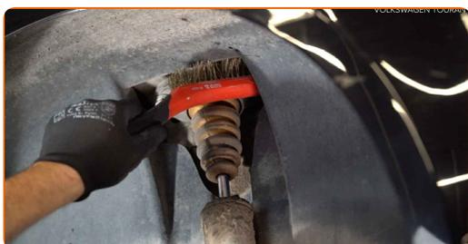
**8** Svitare l'elemento di fissaggio del supporto di ammortizzazione. Utilizza una chiave a bussola N°16.
