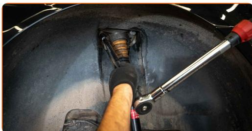
**23** Stringi l'elemento di fissaggio inferiore dell'ammortizzatore. Utilizza una chiave a bussola N°21. Usa una chiave dinamometrica. Serralo fino allo coppia di torsione di 180 Nm.
