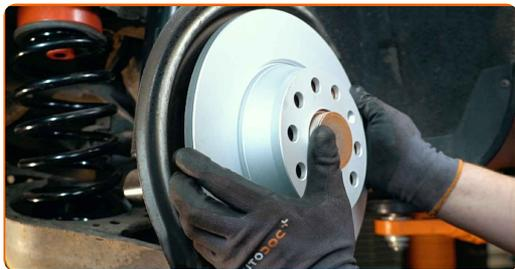
**26** Serrare l'attacco del disco freno. Usa la chiave Torx T30. Usa una chiave dinamometrica. Serralo fino allo coppia di torsione di 4 Nm.
