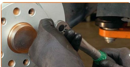
**27** Pulire il sostegno pinza freno da sporco e polvere. Usa una spazzola metallica. Usa un pulitore freni.
