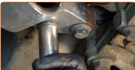
**21** Avvita l'elemento di fissaggio anteriore del braccio. Utilizza una chiave a bussola N°18. Usa una chiave a cricchetto.
