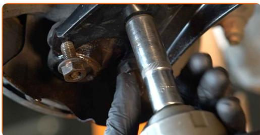
**17** Installa l'elemento di fissaggio posteriore del braccio.
