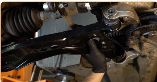
Sostituzione: braccio inferiore anteriore - SEAT Altea (5P1). AUTODOC raccomanda:
