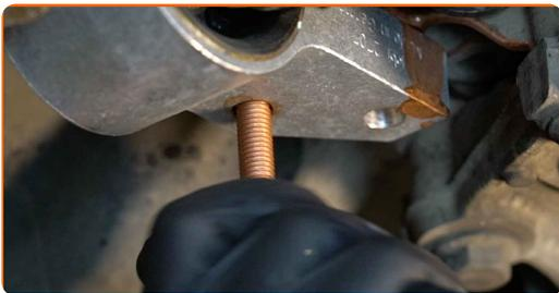
**20** Avvita gli elementi di fissaggio posteriori che collegano il braccio di sospensione al sottotelaio. Utilizza una chiave combinata N°16. Utilizza una chiave a bussola N°16. Usa una chiave a cricchetto.
