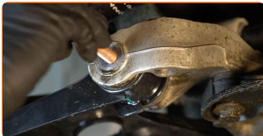
**16** Avvita gli elementi di fissaggio del giunto sferico. Utilizza una chiave a bussola N°16. Usa una chiave a cricchetto.
