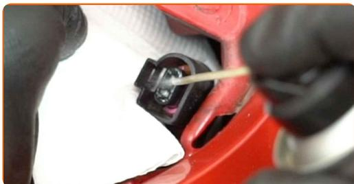
9 Fissare il connettore del faro antinebbia.
