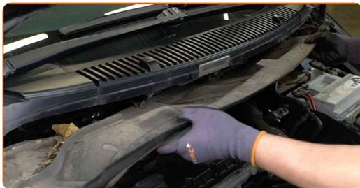
**7** Pulire l'elemento di fissaggio superiore del supporto del puntone di sospensione. Usa una spazzola metallica. Usa lo spray WD-40.
