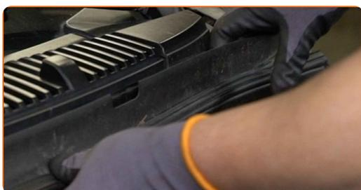
**5** Svitare gli elementi di fissaggio del pannello di plastica. Utilizza una chiave a bussola N°10. Usa una chiave a cricchetto.
