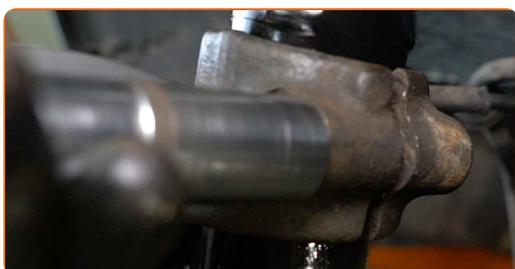
**67** Rimuovi il supporto da sotto il fuso a snodo.
