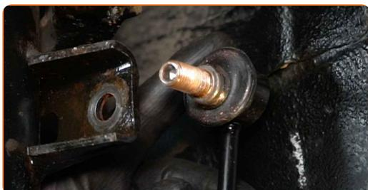
**18** Scollegare il cablaggio del sensore ABS.
