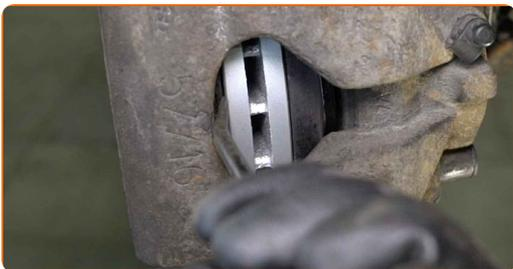
**21** Pulisci gli elementi di fissaggio del supporto pinza freno. Usa una spazzola metallica. Usa lo spray WD-40.
