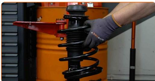
**58** Pulisci le sedi di montaggio del puntone dell'ammortizzatore. Usa una spazzola metallica. Usa lo spray WD-40.
