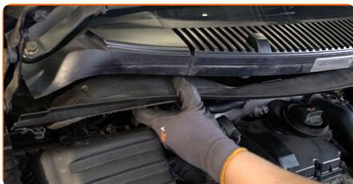
**97** Avvitare gli elementi di fissaggio del pannello di plastica. Utilizza una chiave a bussola N°10. Usa una chiave a cricchetto.
