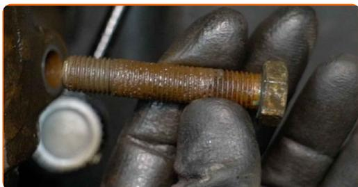
**30** Pulire gli elementi di fissaggio che collegano il giunto sferico al fuso a snodo dello sterzo. Usa una spazzola metallica. Usa lo spray WD-40.
