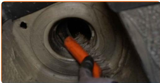
**59** Pulire gli elementi di fissaggio che collegano il giunto sferico al fuso a snodo dello sterzo. Usa una spazzola metallica. Usa lo spray WD-40.
