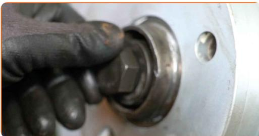
**71** Avvitare l'elemento di fissaggio del semiasse. Utilizza una chiave a bussola N°27. Usa una chiave a cricchetto.
