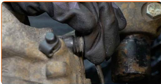
**21** Installare la molla di fissaggio della pinza freno. Usa un piede di porco.
