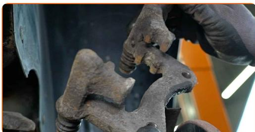
**20** Pulire l'elemento di fissaggio del disco del freno. Usa una spazzola metallica. Usa lo spray WD-40.
