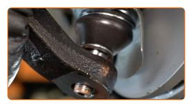
Stringere gli elementi di fissaggio che collegano il giunto sferico al braccio di controllo. Utilizza una chiave a bussola N°22. Usa una chiave dinamometrica. Serralo fino allo coppia di torsione di 30 Nm. +90°
