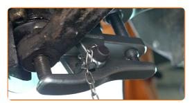
Svitare gli elementi di fissaggio del giunto sferico dal fuso a snodo dello sterzo. Usa una chiave HEX N.H8. Usa una chiave a cricchetto.
