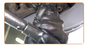
Serrare gli elementi di fissaggio che collegano il giunto sferico al fuso a snodo dello sterzo. Usa una chiave HEX N.H8. Usa una chiave dinamometrica. Serralo fino allo coppia di torsione di 55 Nm.
