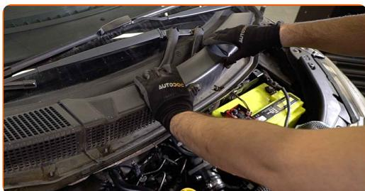
**68** Avvita agli elementi di fissaggio della griglia del sottoparabrezza posizionata sul lato sinistro. Utilizza una chiave a bussola N°10.
