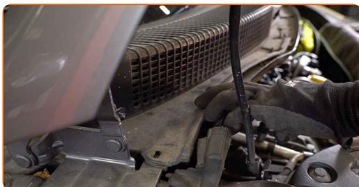
**66** Avvita gli elementi di fissaggio della griglia sottoparabrezza posizionata sul lato destro. Usa la chiave Torx T20.
