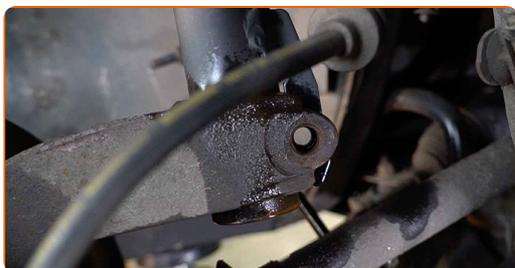
**48** Tratta con del prodotto gli elementi di fissaggio del puntone dell'ammortizzatore. Usa lo spray WD-40.
