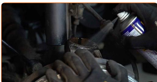
**45** Fissare il supporto di ammortizzazione sul fuso a snodo.
