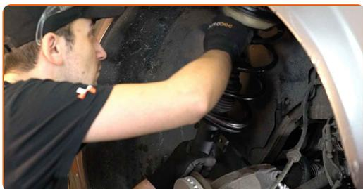
**43** Avvita l'elemento di fissaggio superiore del montante supporto ammortizzazione. Non lo serrare.
