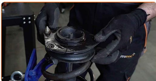
**39** Serrare la vite dell'asta pistone supporto ammortizzazione. Utilizza una chiave combinata N°19. Usa una chiave HEX N.H6. Usa una chiave dinamometrica. Serralo fino allo coppia di torsione di 60 Nm.
