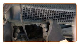
Pulisci gli elementi di fissaggio del supporto superiore del puntone dell'ammortizzatore. Usa una spazzola metallica. Usa lo spray WD-40.
