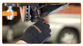
Stringi gli elementi di fissaggio del giunto sferico. Utilizza una chiave a bussola N°17. Usa una chiave a cricchetto. Usa una chiave dinamometrica. Serralo fino allo coppia di torsione di 60 Nm.
