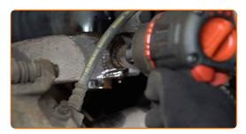
Pulisci la sede di montaggio del giunto sferico. Usa una spazzola metallica. Usa lo spray WD-40.
