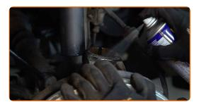
Fissare il supporto di ammortizzazione sul fuso a snodo.
