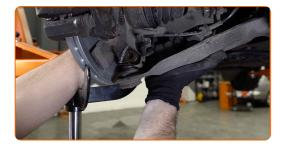
Rimuovi il supporto da sotto il fuso a snodo.
