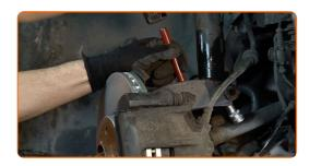
Svita l'elemento di fissaggio superiore del montante supporto ammortizzazione. Utilizza una chiave a bussola N°13. Usa una chiave a cricchetto.
