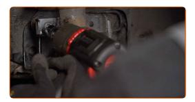
Scollegare il cablaggio e il tubo flessibile freno dalla staffa del supporto di ammortizzazione. Usa un piede di porco.
