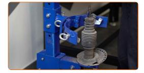
Rimuovi il parapolvere e il paracolpi dell'ammortizzatore.
