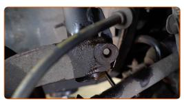
Tratta con del prodotto gli elementi di fissaggio del puntone dell'ammortizzatore. Usa lo spray WD-40.
