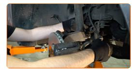
Svita gli elementi di fissaggio che collegano il puntone dell'ammortizzatore al fuso a snodo. Utilizza una chiave a bussola N°18. Usa un giramaschi.
