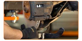
Sgancia gli elementi di fissaggio che collegano il puntone dell'ammortizzatore al fuso a snodo. Usa una chiave a bussola specifica per rimuovere l'ammortizzatore. Usa una chiave a cricchetto.
