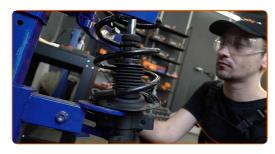
Installare il supporto di ammortizzazione nell'arco passaruota.
