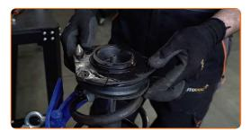
Serrare la vite dell'asta pistone supporto ammortizzazione. Utilizza una chiave combinata N°19. Usa una chiave HEX N.H6. Usa una chiave dinamometrica. Serralo fino allo coppia di torsione di 60 Nm.
