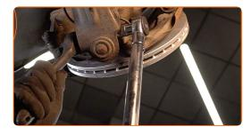
Serra gli elementi di fissaggio inferiori che collegano l'ammortizzatore al fuso a snodo. Utilizza una chiave a bussola N°18. Usa una chiave dinamometrica. Serralo fino allo coppia di torsione di 105 Nm.
