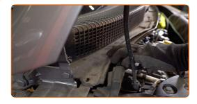
Avvita gli elementi di fissaggio della griglia sottoparabrezza posizionata sul lato destro. Usa la chiave Torx T20.
