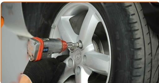
**28** Rimettere il veicolo per terra e, lavorando in ordine incrociato, serrare i bulloni di fissaggio delle ruote. Usa la chiave a bussola per dadi cerchio ruota n.21. Usa una chiave dinamometrica. Serralo fino allo coppia di torsione di 108 Nm.
