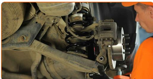
**20** Installa l'elemento di fissaggio anteriore del braccio.
