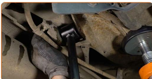
Sostituzione: braccio oscillante inferiore della sospensione posteriore - Lexus RX XU30. Consiglio:
