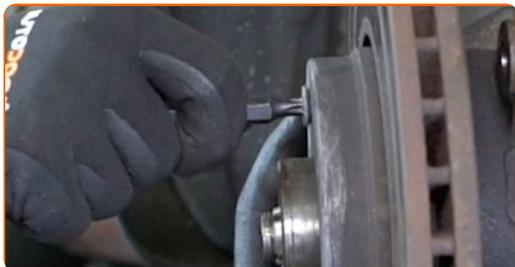
**65** Serrare gli elementi di fissaggio del disco del freno. Usa la chiave Torx T40. Usa una chiave dinamometrica. Serralo fino alla coppia di torsione di 10 Nm.
