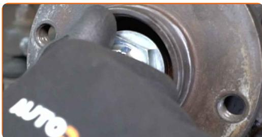
**60** Avvitare l'elemento di fissaggio del semiassse. Utilizza una chiave a bussola N°30. Usa una chiave a cricchetto.
