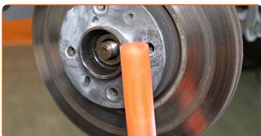
**15** Svitare gli elementi di fissaggio del disco del freno. Usa la chiave Torx T40. Usa un cacciavite a percussione.
