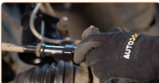
**18** Avvita il dado di serraggio che collega le testine tiranti dello sterzo al fuso a snodo. Utilizza una chiave a bussola N°17.
